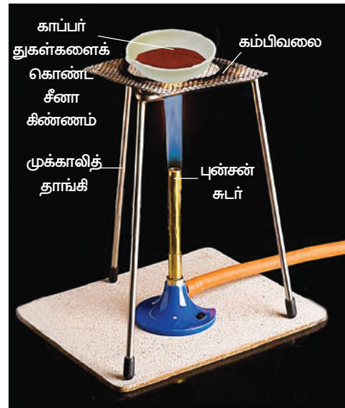
படம்-13(c): காப்பர் ஆக்ஸைடாக காப்பர் ஆக்சிஜனேற்றம் அடைதல்
