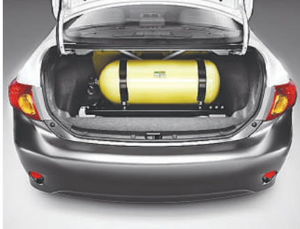
படம்-2:காரில் இருக்கும் CNG சிலிண்டர்
