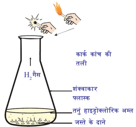
चित्र-2: जस्ते पर तनु हाइड्रोक्लोरिक अम्ल की क्रिया से \text{H}_2 गैस का बनना और \text{H}_2 गैस का परीक्षण
