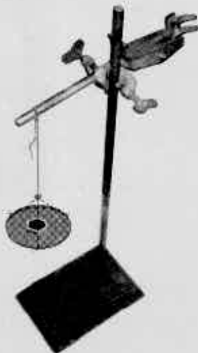
ਚਿੱਤਰ 3.5 : ਇੱਕ ਲੋਹੇ ਦੇ ਸਟੈਂਡ ਤੇ ਕਲੈੱਪ ਨਾਲ ਲਟਕਦਾ ਹੋਇਆ ਇੱਕ ਧਾਗਾ।
