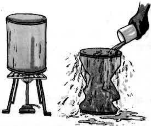
ਚਿੱਤਰ 8.2 ਗਰਮ ਪਾਣੀ ਨਾਲ ਭਰਿਆ ਡੱਬਾ ਜਿਸ ਨੂੰ ਠੰਡਾ ਕੀਤਾ ਜਾ ਰਿਹਾ ਹੈ
