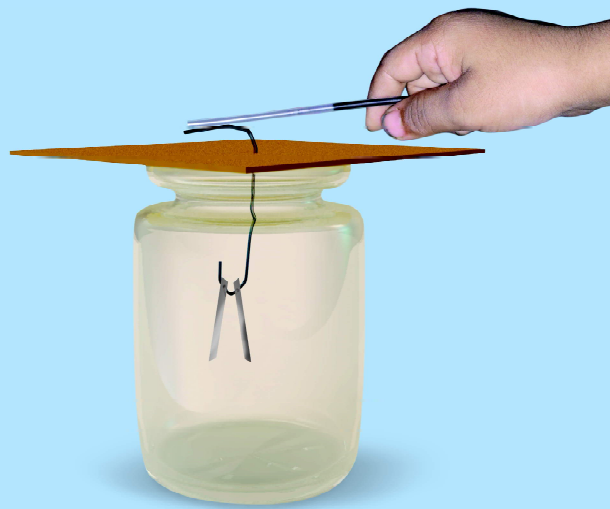
Fig 15.4 : A simple electroscope
