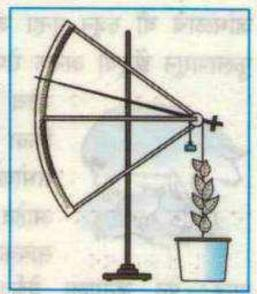
खोडाच्या टोकाला झालेल्या वाढीमुळे दोरा वर सरकतो. त्यामुळे कप्पी फिरते आणि कप्पीला जोडलेला काटा पुढे सरकतो, म्हणजेच झाडाच्या उंचीत झालेली वाढ आर्क इंडिकेटरच्या कमानीवर दर्शवली जाते.
