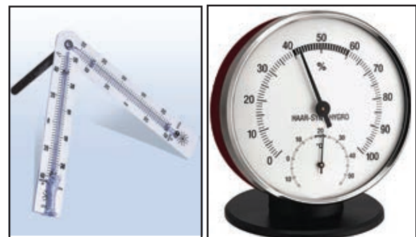
Fig 2.7 : Psychrometer Fig 2.8 : Hygrometer
