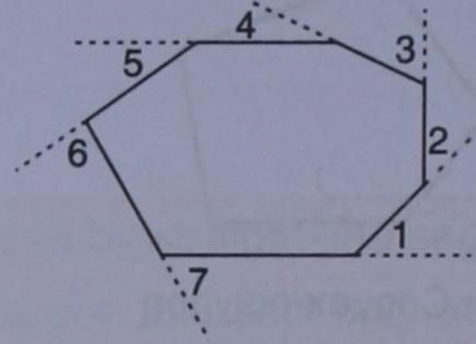
$$[\angle 1 + \angle 2 + \dots + \angle 7 = 360^\circ]$$
