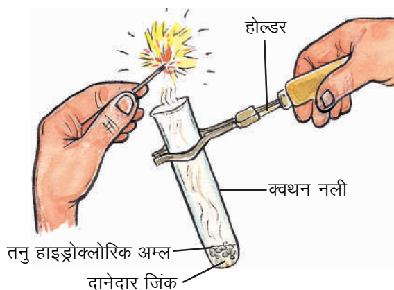
चित्र क्रमांक-2 : जिंक पर तनु हाइड्रोक्लोरिक अम्ल की क्रिया से H 2 गैस का बनना
