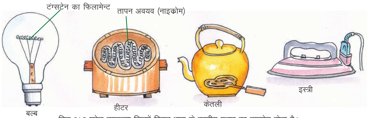
चित्र 21.5 घरेलू उपकरण जिनमें विद्युत धारा के ऊष्मीय प्रभाव का उपयोग होता है।
