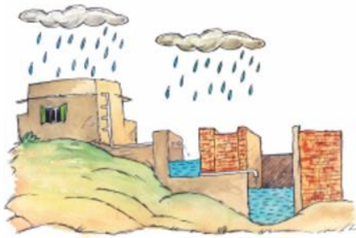
चित्र 16.6 शहर में मकान की छत पर जमा वर्षा का जल पाइप की सहायता से टैंक में पहुँचाया जा रहा है।
